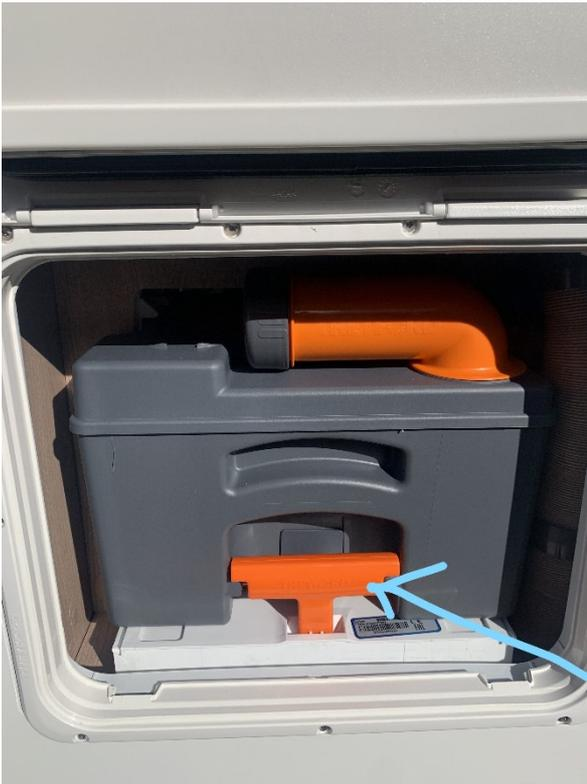
Einfach den orangefarbenen Sicherungs-Hebel nach außen klappen, den Behälter herausnehmen und bei der Entsorgungsstation entleeren. Nach dem Entleeren, auch bei Rückankunft bitte den Behälter mehrmals mit dem Wasserschlauch ausspülen und auch wieder mehrmals entleeren. Nach dem richtigen Einsetzen den Hebel wieder nach oben ziehen und die Tür schließen. Danach von der Toilette aus dem Becher mit 1 Liter Wasser und 2 Beuteln - BIOersetzer wieder eingießen.
