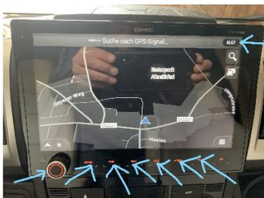
Von links nach rechts befinden sich folgende Knöpfe: Vol. für lauter u. leiser drehen, Homeputton, TUN für Radio, mit dem Vol-Regler die Frequenz noch oben oder unten regeln, CAM für Rückfahrkamera, welche sich beim Einlegen des Rückwärtsganges von
