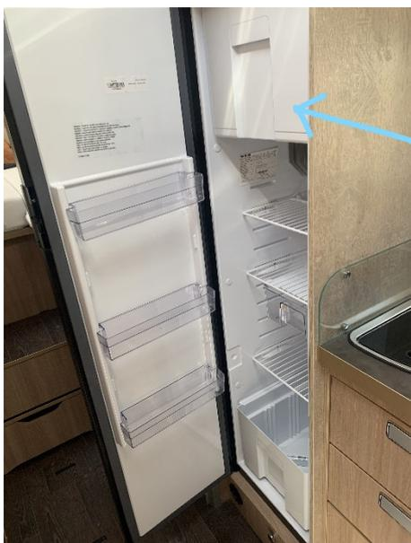
Zuerst kontrollieren ob der Kühlschrank überhaupt eingeschaltet ist. Dies erkennt am linken Knopf. Dieser muss blau leuchten. Durch Drücken des mittleren Knopfes und danach mit den Pfeiltasten kann man die gewünschte Kühlfunktion einstellen A = Automatik, hier schaltet der Kühlschrank entweder immer auf Gas oder bei 230 V-Anschluss, dann immer auf Strom. Wenn ganz rechts die LEDs blinken, kann man noch die gewünschte Kühlstärke einstellen.
