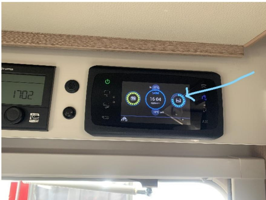
Die nächste Anzeige ist Außenlicht. AUX schaltet alle USB-Anschlüsse z.B. am Heckbett und am Hubbett auch ein.
