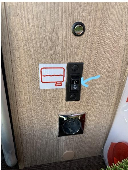
Ist der Abwassertank entleert einfach wieder auf den Wippschalter unten mehrere Sekunden drücken und den Abwassertank schließen.
